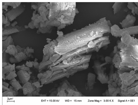
Figura 4. Partículas de \alpha -espodumeno originales atacadas
